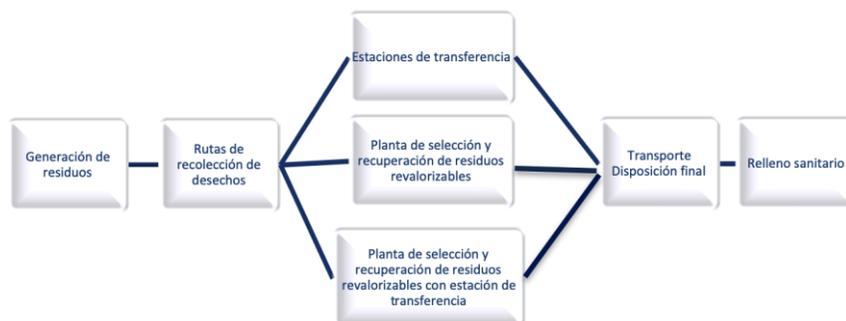
***Figura 1 Estaciones de transferencia para optimización de transporte y Planta de selección y recuperación de residuos valorizables.***
